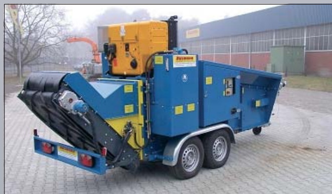
HFG II 80 km/h max. sebességű kéttengelyes alvázon
