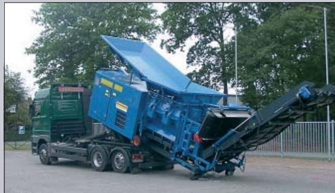
B) Villanymotorral (2 × 160 kW) ellátott, fix helyű üzemeltetésre kialakított aprítógép
