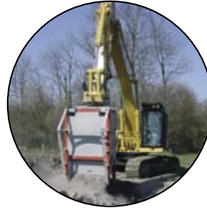
e.p.m - finomszemcsés anyag terítésére szolgáló berendezés - permetezi a kötőanyagot
