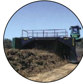
ALLU AS prizmaforgató - nagy mennyiségben keveri a talajt és a kötőanyagot
